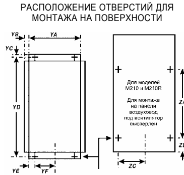
МОНТАЖНЫЕ ОТВЕРСТИЯ М6 (1/4 дюйма)
