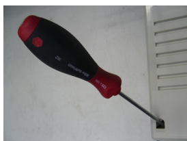
Haken mit einem Schraubendreher herunterdrücken
