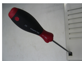
Rimuovi il Pannello di Controllo Del DCS550, se presente. Premere I blocchi per rimuovere il coperchio
